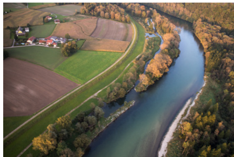
Durch Entfernung der Ufersicherung ist rechts ein natürliches Ufer mit vorgelagerter Schotterbank entstanden. Links erfolgte die Anbindung eines Altarms an die Traun.
